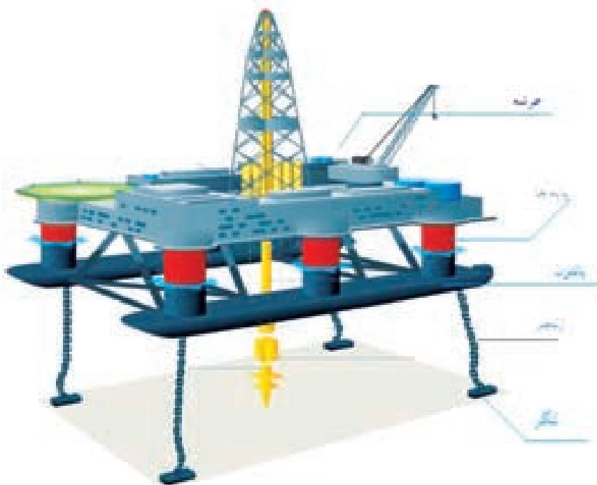
شکل ۲-۴: سیستم‌های مختلف اسکوی نیمه شناور
