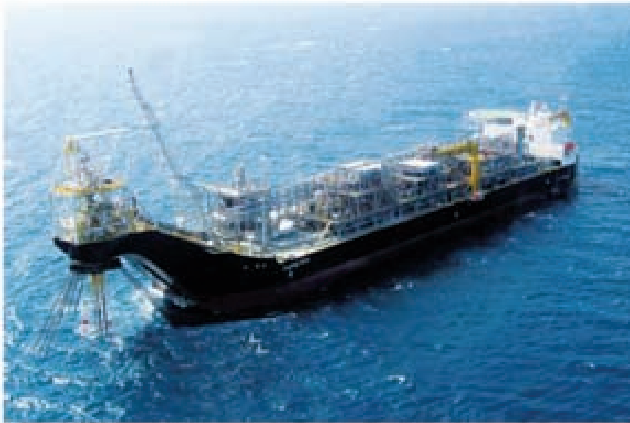
شکل ۱۳-۵: شناور بهره‌برداری ذخیره و تغلیبه
